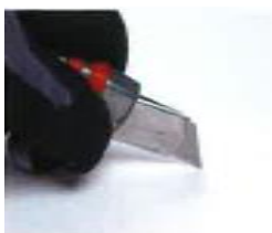
Provedení křížového řezu
